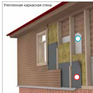
Утепленная каркасная стена
